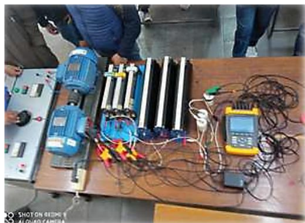
Fotografía 2: Mediciones en el generador de inducción. Crédito: NS. Mamani V. 2023
