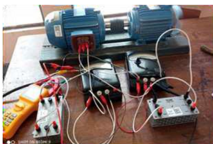
Fotografía 1: Ensayo en rotor trabado y en vacío Crédito: NS. Mamani V., 2023
