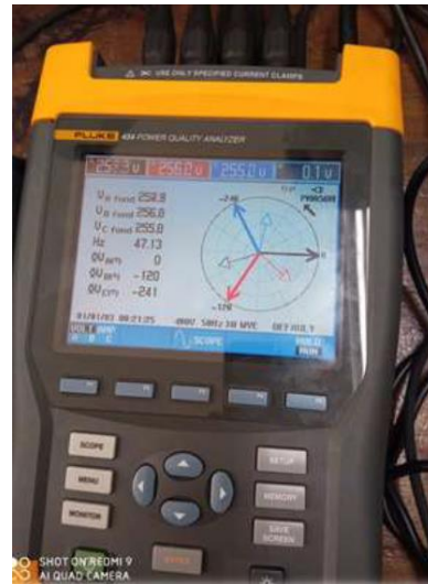
Fotografía 4: Voltajes, desfases, frecuencia y diagrama fasorial del generador de inducción en régimen estacionario con medidor de calidad de energía. Crédito: NS. Mamani V. 2023
