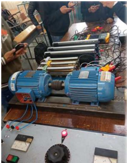
Fotografía 3: Generador de inducción autoexcitado con carga y medidor de calidad de energía. Crédito: NS. Mamani V. 2023
